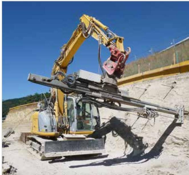
Exaktes Ausrichten der Anbaulafette am Bohrersatzpunkt.
